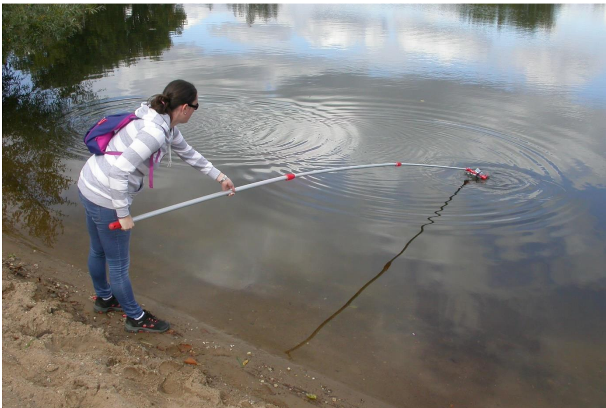
Obr. 3. Odběr pomocí odběrové tyče z horizontu 0 – 10 cm.
