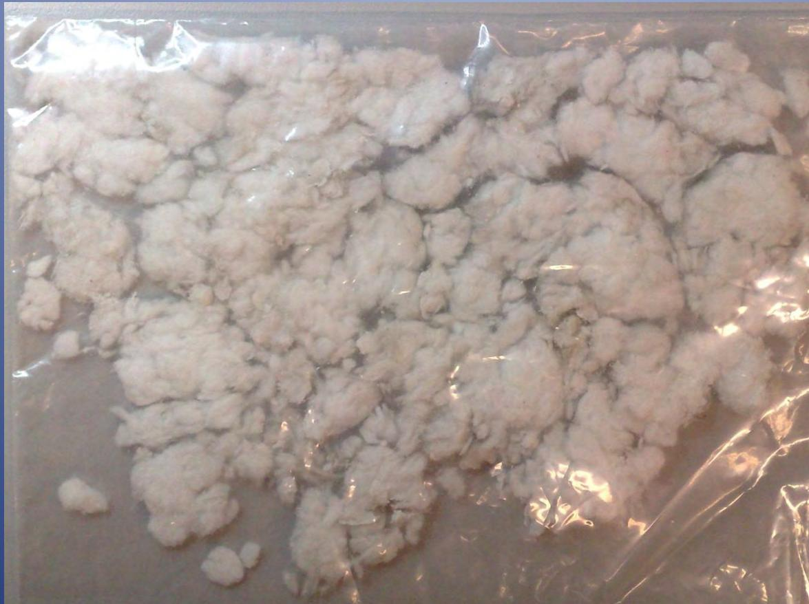
Příklady dodaných vzorků na identifikaci azbestových vláken
