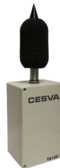
Čidlo Cesva TS120 pro měření úrovně hluku
