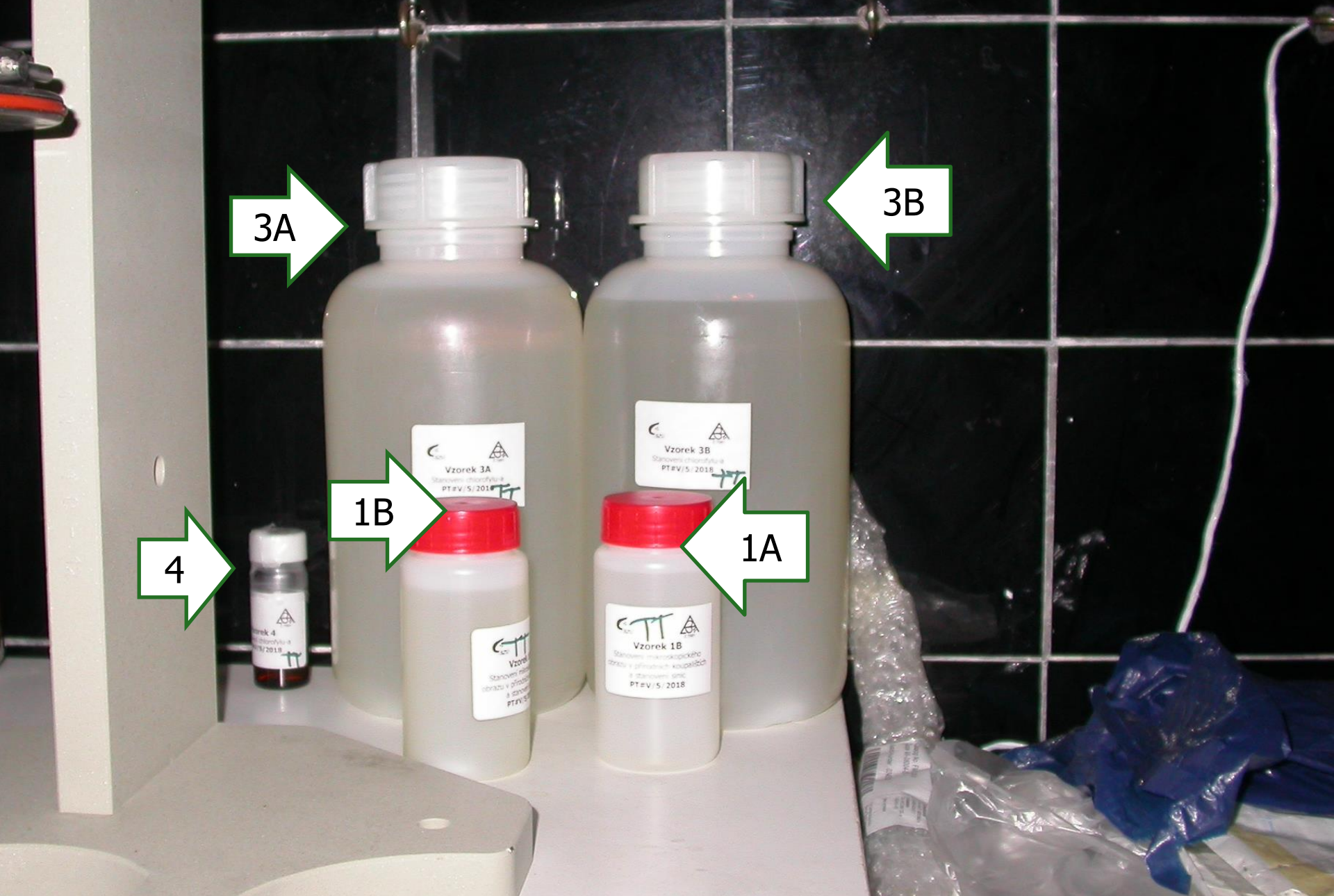
Testování stability / robustnosti – cca den ve tmě při laboratorní teplotě (foto z roku 2018)
