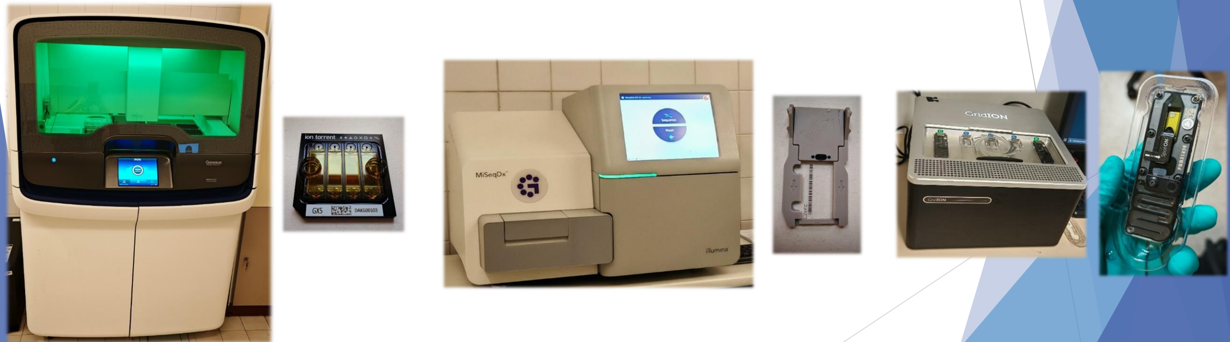
Obrázek 1: a) Genexus, b) čip do Genexusu, c) Illumina MiSeqDx, d) flow cela do Illumina platform, e) Oxford Nanopore GridION, f) flow cela pro Oxord Nanopore. Zdroj: foto autora (a – d: vybavení SZÚ budova 12, e – f: vybavení MHRA, Londýn).
