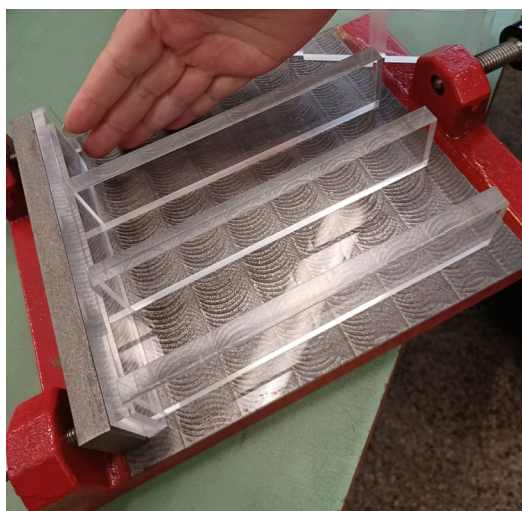
Obr. č. 2 Forma na normalizované trámečky
